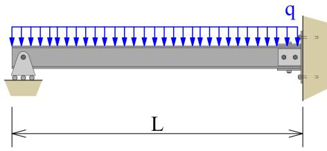
V případě staticky neurčitého nosníku je nutné chybějící podmínky rovnováhy doplnit deformačními podmínkami.
