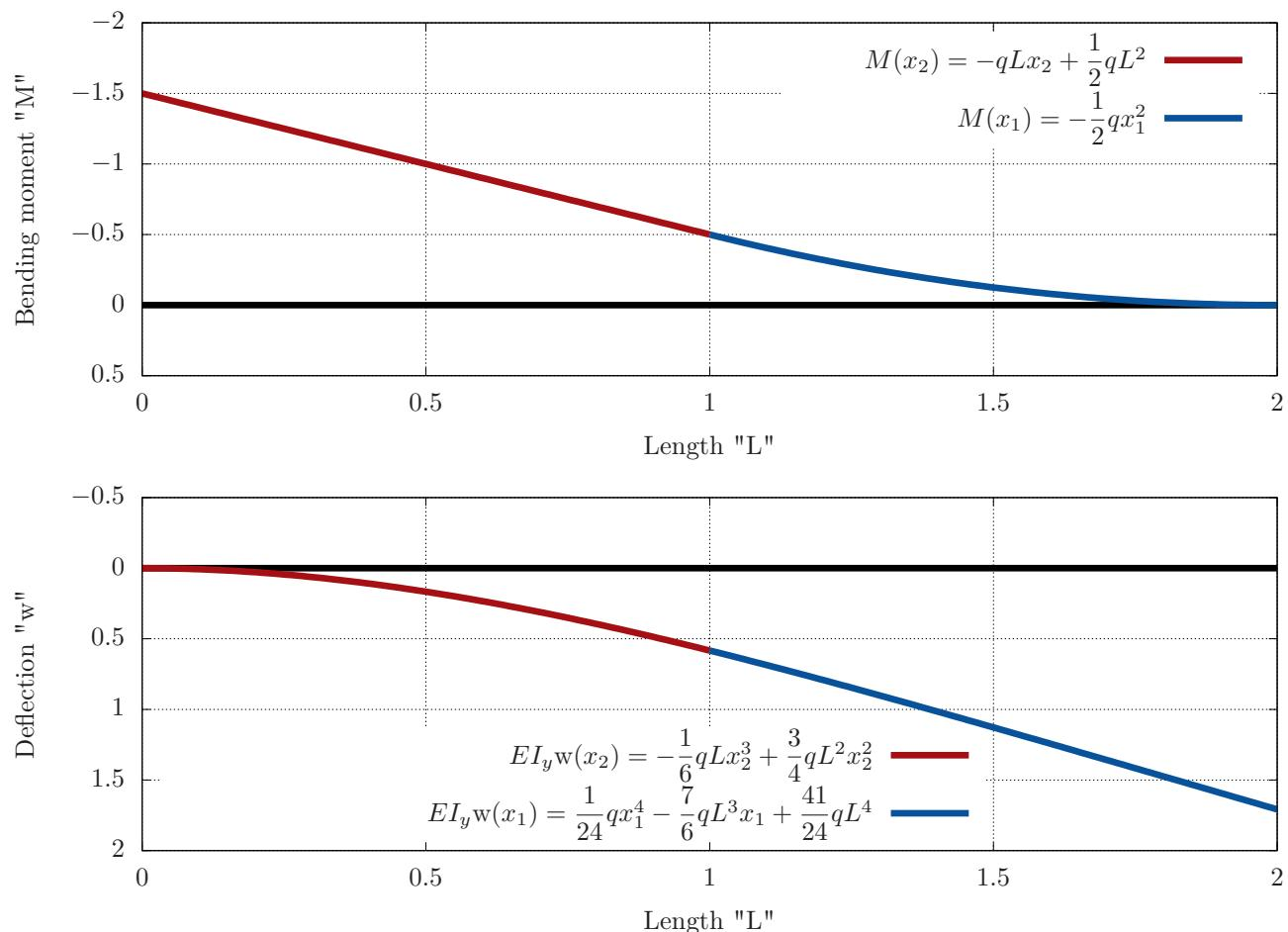
Výše uvedené postupy ukazují nejrychlejší řešení (bez využití SW nástrojů) od intervalu  $\vec{x}_2 \in \langle 0, L \rangle$  pro vyjádření  $\varphi(L)$ ,  $w(L)$  a následně  $\vec{x}_1 \in \langle 0, L \rangle$ .
