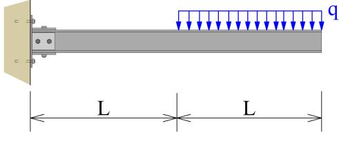
Při vyšetřování průhybu nosníku analytickým způsobem vycházíme z (Bernoulliho) differenciální rovnice průhybové čáry
